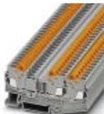
Проходные клеммы, номинальное напряжение: 800 В, номинальный ток: 24 А, тип подключения: Быстрое подключение, количество точек подсоединения: 3, сечение: 0,5 мм<sup>2</sup> - 2,5 мм<sup>2</sup>, AWG: 20 - 14, ширина: 6,2 мм, высота: 37,8 мм, цвет: серый, тип монтажа: NS 35/7,5, NS 35/7,5
