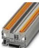
Клемма для быстрого подключения, номинальное напряжение: 800 В, номинальный ток: 17,5 А, тип подключения: Быстрое подключение, количество точек подсоединения: 2, сечение: 0,25 мм<sup>2</sup> - 1,5 мм<sup>2</sup>, AWG: 24 - 16, ширина: 5,2 мм, цвет: серый, тип монтажа: NS 35/7,5, NS 35/15
