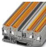
Проходные клеммы, номинальное напряжение: 800 В, номинальный ток: 17,5 А, тип подключения: Быстрое подключение, количество точек подсоединения: 4, сечение: 0,25 мм<sup>2</sup> - 1,5 мм<sup>2</sup>, AWG: 24 - 16, ширина: 5,2 мм, цвет: серый, тип монтажа: NS 35/7,5, NS 35/7,5
