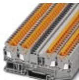
Проходные клеммы, номинальное напряжение: 800 В, номинальный ток: 17,5 А, тип подключения: Быстрое подключение, количество точек подсоединения: 4, сечение: 0,25 мм<sup>2</sup> - 1,5 мм<sup>2</sup>, AWG: 24 - 16, ширина: 5,2 мм, цвет: серый, тип монтажа: NS 35/7,5, NS 35/7,5
