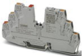
Одноканальный электронный автоматический выключатель для защиты потребителей сети 24 В DC при перегрузке и коротком замыкании. Простое распределение потенциалов при помощи компонентов из системы клеммных блоков CLIPLINE complete. С электронной блокировкой настроенных номинальных токов. Для установки на несущих DIN-рейках.
