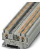
Проходные клеммы, номинальное напряжение: 800 В, номинальный ток: 24 А, тип подключения: Зажимы Push-in, количество точек подсоединения: 3, сечение: 0,14 мм<sup>2</sup> - 4 мм<sup>2</sup>, AWG: 26 - 12, ширина: 5,2 мм, высота: 35,2 мм, цвет: серый, тип монтажа: NS 35/7,5, NS 35/15
