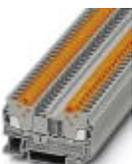
Проходные клеммы, номинальное напряжение: 800 В, номинальный ток: 24 А, тип подключения: Быстрое подключение, количество точек подсоединения: 2, сечение: 0,5 мм<sup>2</sup> - 2,5 мм<sup>2</sup>, AWG: 20 - 14, ширина: 6,2 мм, цвет: серый, тип монтажа: NS 35/7,5, NS 35/15
