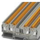
Проходные клеммы, номинальное напряжение: 800 В, номинальный ток: 24 А, тип подключения: Быстрое подключение, количество точек подсоединения: 4, сечение: 0,5 мм<sup>2</sup> - 2,5 мм<sup>2</sup>, AWG: 20 - 14, ширина: 6,2 мм, высота: 37,8 мм, цвет: серый, тип монтажа: NS 35/7,5, NS 35/7,5
