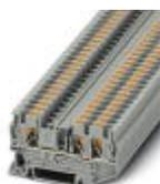
Проходные клеммы, номинальное напряжение: 800 В, номинальный ток: 32 А, тип подключения: Зажимы Push-in, количество точек подсоединения: 3, сечение: 0,2 мм<sup>2</sup> - 6 мм<sup>2</sup>, AWG: 24 - 10, ширина: 6,2 мм, цвет: серый, тип монтажа: NS 35/7,5, NS 35/15
