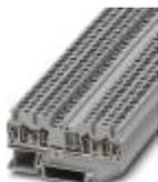
Проходные клеммы, номинальное напряжение: 800 В, номинальный ток: 24 А, тип подключения: Пружинный зажим, количество точек подсоединения: 4, сечение: 0,08 мм<sup>2</sup> - 4 мм<sup>2</sup>, AWG: 28 - 12, ширина: 5,2 мм, цвет: серый, тип монтажа: NS 35/7,5, NS 35/15
