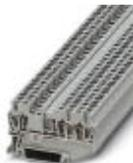
Проходные клеммы, номинальное напряжение: 800 В, номинальный ток: 24 А, тип подключения: Пружинный зажим, количество точек подсоединения: 3, сечение: 0,08 мм<sup>2</sup> - 4 мм<sup>2</sup>, AWG: 28 - 12, ширина: 5,2 мм, цвет: серый, тип монтажа: NS 35/7,5, NS 35/15
