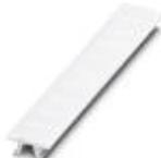
Планка Zack, Полоса, белый, без маркировки, маркируется с помощью: CMS-P1-PLOTTER, PLOTMARK, тип монтажа: крепление в высоких пазах для табличек, для клемм шириной: 6,2 мм, размер маркировочного поля: 6,15 x 10,5 мм
