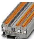
Проходные клеммы, номинальное напряжение: 800 В, номинальный ток: 17,5 А, тип подключения: Быстрое подключение, количество точек подсоединения: 3, сечение: 0,25 мм<sup>2</sup> - 1,5 мм<sup>2</sup>, AWG: 24 - 16, ширина: 5,2 мм, цвет: серый, тип монтажа: NS 35/7,5, NS 35/7,5
