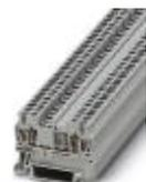
Проходные клеммы, номинальное напряжение: 800 В, номинальный ток: 24 А, тип подключения: Пружинный зажим, количество точек подсоединения: 2, сечение: 0,08 мм<sup>2</sup> - 4 мм<sup>2</sup>, AWG: 28 - 12, ширина: 5,2 мм, цвет: серый, тип монтажа: NS 35/7,5, NS 35/15
