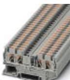
Проходные клеммы, номинальное напряжение: 800 В, номинальный ток: 32 А, тип подключения: Зажимы Push-in, количество точек подсоединения: 4, сечение: 0,2 мм<sup>2</sup> - 6 мм<sup>2</sup>, AWG: 24 - 10, ширина: 6,2 мм, высота: 35,3 мм, цвет: серый, тип монтажа: NS 35/7,5, NS 35/15
