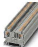
Проходные клеммы, номинальное напряжение: 800 В, номинальный ток: 24 А, тип подключения: Зажимы Push-in, количество точек подсоединения: 2, полюсов: 1, сечение: 0,14 мм<sup>2</sup> - 4 мм<sup>2</sup>, AWG: 26 - 12, ширина: 5,2 мм, высота: 35,3 мм, цвет: серый, тип монтажа: NS 35/7,5, NS 35/15
