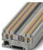
Проходные клеммы, номинальное напряжение: 800 В, номинальный ток: 24 А, тип подключения: Зажимы Push-in, количество точек подсоединения: 4, сечение: 0,14 мм<sup>2</sup> - 4 мм<sup>2</sup>, AWG: 26 - 12, ширина: 5,2 мм, высота: 35,3 мм, цвет: серый, тип монтажа: NS 35/7,5, NS 35/15
