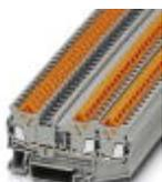
Проходные клеммы, номинальное напряжение: 800 В, номинальный ток: 17,5 А, тип подключения: Быстрое подключение, количество точек подсоединения: 3, сечение: 0,25 мм<sup>2</sup> - 1,5 мм<sup>2</sup>, AWG: 24 - 16, ширина: 5,2 мм, цвет: серый, тип монтажа: NS 35/7,5, NS 35/7,5
