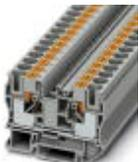
Проходные клеммы, номинальное напряжение: 1000 В, номинальный ток: 57 А, тип подключения: Зажимы Push-in, количество точек подсоединения: 2, сечение: 0,5 мм<sup>2</sup> - 16 мм<sup>2</sup>, AWG: 20 - 6, ширина: 10,2 мм, высота: 49,5 мм, цвет: серый, тип монтажа: NS 35/7,5, NS 35/15
