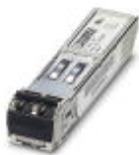
Гигабитный модуль SFP для передачи данных на расстояние до 2 км с длиной волны 1310 нм.
