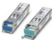
Комплект Gigabit SFP WDM для передачи данных на расстояние до 10 км по оптоволоконной линии с длиной волны 1310/1550 нм.
