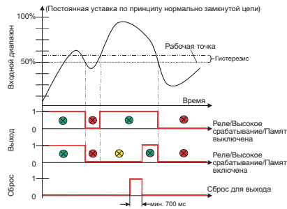
Рис. 2: Контроль понижения напряжения Аварийная уставка на «низкое срабатывание» (Постоянная уставка по принципу нормально замкнутой цепи)
