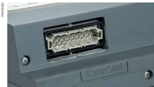
Опциональный разъем низкого напряжения позволяет подсоединять вспомогательные цепи выключателя к шкафу управления распределительным устройством при любом положении выключателя: «выкачен» или «рабочее». Он состоит из 64-контактного штыревого разъема, установленного на раме выключателя и съемного 64-контактного гнездового разъема. Кабелепровод длиной 525 мм со штыревым разъемом обеспечивает безопасность электропроводки, которая соединяет выключатель с отсеком НН ячейки.
