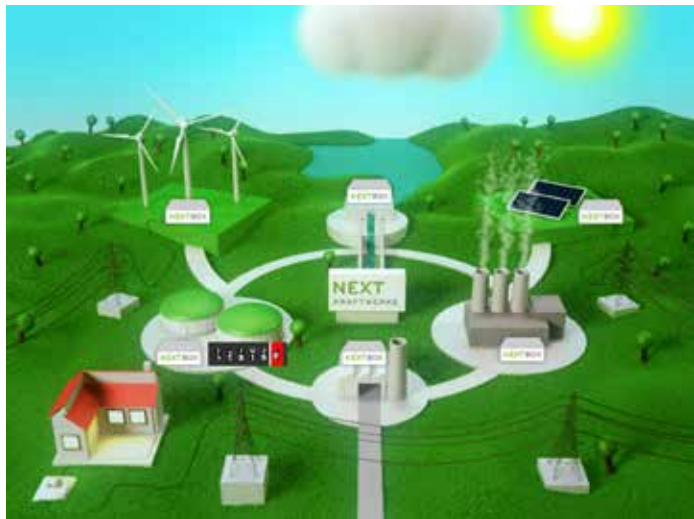
Рис. 3. Концепция виртуальной электрической сети. Реализовано для генерирующей компании, эксплуатирующей более 2 800 станций общей мощностью 1,5 ГВт
