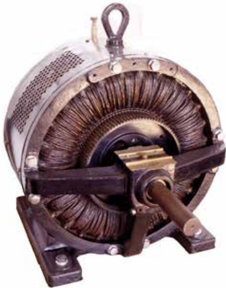
Рис. 5. Асинхронный двигатель конструкции Доливо-Добровольского – Арнольда
