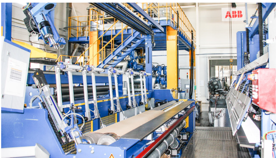
Намотка остова по заданным техническим параметрам
