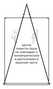
Принципиальная схема подъёма ячейки
