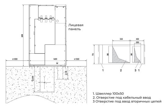
Рис. 9 Чертеж с размерами фундамента устройства
