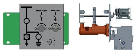
Рис. 5 Трехпозиционный разъединитель
