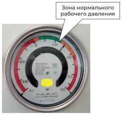
Рис. 3 Манометр
