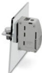
Проходная клемма, тип подключения: Винтовые зажимы, Подсоединение кабельного наконечника, ток нагрузки: 232 А, сечение: 25 мм<sup>2</sup> - 95 мм<sup>2</sup>, ширина: 25 мм, цвет: серый
