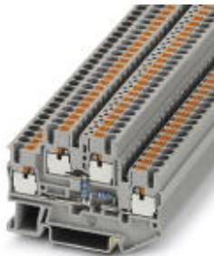
Клеммный блок, тип подключения: Зажимы Push-in, сечение: 0,14 мм<sup>2</sup> - 4 мм<sup>2</sup>, AWG: 26 - 12, ширина: 5,2 мм, цвет: серый, тип монтажа: NS 35/7,5, NS 35/15
