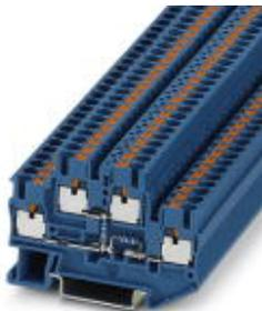
Клеммный блок, тип подключения: Зажимы Push-in, сечение: 0,14 мм<sup>2</sup> - 4 мм<sup>2</sup>, AWG: 26 - 12, ширина: 5,2 мм, цвет: синий, тип монтажа: NS 35/7,5, NS 35/15
