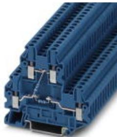
Клеммный блок, тип подключения: Винтовые зажимы, сечение: 0,14 мм<sup>2</sup> - 4 мм<sup>2</sup>, AWG: 26 - 12, ширина: 5,2 мм, цвет: синий, тип монтажа: NS 35/7,5, NS 35/15
