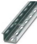
DIN-рейка, с перфорацией, Стандартный профиль, ширина: 35 мм, высота: 15 мм, соотв. EN 60715, материал: Сталь, оцинковка, белая пассивация, длина: 2000 мм, цвет: серебристый
