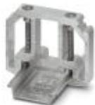
Концевой держатель, служит в качестве концевой опоры для UKH 50 - UKH 240, вставляется в монтажную рейку NS 35 и закрепляется 2 винтами, ширина: 10 мм, цвет: под алюминий
