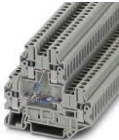
Клеммный блок, тип подключения: Винтовые зажимы, сечение: 0,14 мм<sup>2</sup> - 4 мм<sup>2</sup>, AWG: 26 - 12, ширина: 5,2 мм, цвет: серый, тип монтажа: NS 35/7,5, NS 35/15
