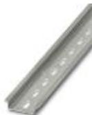
DIN-рейка, с перфорацией, Стандартный профиль, ширина: 35 мм, высота: 7,5 мм, согласно EN 60715, материал: Сталь, оцинкован., пассивирован., длина: 2000 мм, цвет: серебристый
