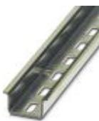
DIN-рейка, с перфорацией, Стандартный профиль, ширина: 35 мм, высота: 15 мм, соотв. EN 60715, материал: Сталь, оцинкован., пассивирован., длина: 2000 мм, цвет: серебристый
