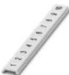
Плоские планки Zack, Полоса, белый, с маркировкой, надписи вдоль: нумерация по порядку 1 ...10, 11 ...20 и т.д. до 491 ...500, тип монтажа: крепление в плоских пазах для табличек, для клемм шириной: 5 мм, размер маркировочного поля: 5,15 x 5,15 мм
