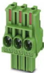
Разъемы для печатной платы, номинальный ток: 32 А, расчетное напряжение (III/2): 1000 В, полюсов: 3, размер шага: 7,62 мм, тип подключения: Ножевые контакты, цвет: зеленый, поверхность контакта: олово
