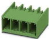
Корпусная часть для печатных плат, номинальный ток: 41 А, расчетное напряжение (III/2): 630 В, полюсов: 3, размер шага: 7,62 мм, цвет: зеленый, поверхность контакта: олово, монтаж: Пайка волной припоя
