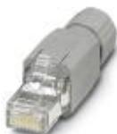
Штекерный соединитель RJ45, степень защиты: IP20, полюсов: 8, 1 Гбит/с, CAT5 (МЭК 11801:2002), материал: PA, тип подключения: Быстрый зажим IDC, сечение проводников: AWG 26- 23, кабельный отвод: прямое, цвет: серый цвет A RAL 7042
