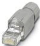
Штекерный соединитель RJ45, степень защиты: IP20, полюсов: 8, 1 Гбит/с, CAT5 (МЭК 11801:2002), материал: PA, тип подключения: Быстрый зажим IDC, сечение проводников: AWG 26- 23, кабельный отвод: прямое, цвет: серый цвет A RAL 7042
