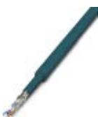
Кабель CAT5-SF/UTP (J-02YS(ST)C HP 2 x 2 x 24 AWG), высокопрочный установочный кабель 2 x 2 x 0,22 мм<sup>2</sup>, одножильный, экранированный, с внешней оболочкой: диаметр 7,8 мм, внутренняя оболочка: диаметр 5,75 ± 0,15 мм, с разъемами RJ45 с обоих концов, с прямой или перекрестной разводкой
