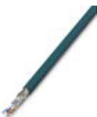
Кабель CAT5-SF/UTP (J-LI02YS(ST)C H 2 x 2 x 26 AWG), легкий, гибкий установочный кабель 2 x 2 x 0,14 мм<sup>2</sup>, из тонких проводников, экранированный, внешняя оболочка: диаметр 5,75 ± 0,15 мм, с разъемами RJ45 с обоих концов, с прямой или перекрестной разводкой
