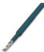
Кабель CAT5-SF/UTP (J-02YS(ST)C HP 2 x 2 x 24 AWG), высокопрочный установочный кабель, 2 x 2 x 0,22 мм<sup>2</sup>, одножильный, экранированный, с внешней оболочкой: диаметр 7,8 мм, внутренняя оболочка: диаметр 5,75 ± 0,15 мм
