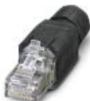
Штекерный соединитель RJ45, степень защиты: IP20, полюсов: 8, 1 Гбит/с, CAT5 (МЭК 11801:2002), материал: PA, тип подключения: Быстрый зажим IDC, сечение проводников: AWG 26- 23, кабельный отвод: прямое, цвет: черный
