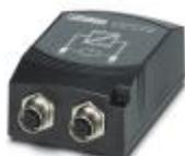
Пассивный сетевой изолятор для гальванической развязки в сетях Ethernet. Предназначен для защиты оборудования Ethernet от перепада потенциалов до 4 кВ. Возможно применение для скорости передачи до 100 Мбит/с. Подключение Ethernet посредством двух гнезд M12 (мех. ключ D).
