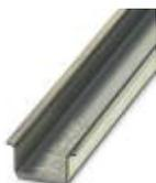
Несущая рейка без перфорации, Стандартный профиль, ширина: 35 мм, высота: 15 мм, соотв. EN 60715, материал: Сталь, оцинкован., пассивирован., длина: 2000 мм, цвет: серебристый
