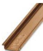
Несущая рейка без перфорации, Стандартный профиль, ширина: 35 мм, высота: 7,5 мм, согласно EN 60715, материал: Медь, без покрытия, длина: 2000 мм, цвет: Под медь
