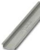
Несущая рейка без перфорации, Стандартный профиль, ширина: 35 мм, высота: 7,5 мм, согласно EN 60715, материал: Сталь, оцинкован., пассивирован., длина: 2000 мм, цвет: серебристый
