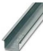
Несущая рейка без перфорации, Стандартный профиль, ширина: 35 мм, высота: 15 мм, соотв. EN 60715, материал: Сталь, оцинковка, белая пассивация, длина: 2000 мм, цвет: серебристый
