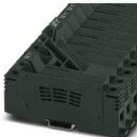
Клеммы для установки предохранителей, тип предохранителя: Стекло / керамика / ..., тип подключения: Винтовые зажимы, сечение: 2,5 мм<sup>2</sup>- 25 мм<sup>2</sup>, AWG: 14 - 4, номинальный ток: 32 А, номинальное напряжение: 1500 В, ширина: 23 мм, тип предохранителей: gG / gPV / 10,3 x 85, тип монтажа: NS 35/7,5, NS 35/15, цвет: черный
