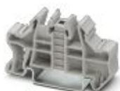
Концевой держатель для быстрого монтажа, для монтажной рейки NS 35/7,5 или NS 35/15, с возможностью нанесения маркировки, ширина: 9,5 мм, цвет: серый
