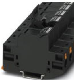
Клеммы для установки предохранителей, тип подключения: Зажимы Push-in, сечение: 1,5 мм<sup>2</sup>- 10 мм<sup>2</sup>, AWG: 16 - 6, номинальный ток: 20 А, номинальное напряжение: 1000 В, ширина: 17,6 мм, тип предохранителей: Миниатюрный / 10,3 x 38, тип монтажа: NS 35/7,5, NS 35/15, цвет: черный
