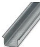
Несущая рейка без перфорации, Стандартный профиль, ширина: 35 мм, высота: 15 мм, соотв. EN 60715, материал: Сталь, оцинкованный, длина: 2000 мм, цвет: серебристый
