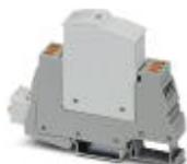
УЗИП типа 3, в комплектации из защитного штекера и базового элемента, со встроенным индикатором состояния и датчиком удаленного оповещения для однофазных электрических сетей. Номинальное напряжение 24 В AC/DC.
