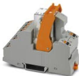
Установленный релейный модуль: релейный блок, функциональный вставной блок, реле с силовыми контактами и поддерживающая скоба, допуски согласно ATEX/IECEx (зона 2) и для взрывоопасной зоны класса I, разд. 2, Зажимы Push-in, 4 переключающих контакта, Входное напряжение: 24 В DC
