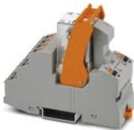
Установленный релейный модуль: релейный блок, функциональный вставной блок, реле с силовыми контактами и поддерживающая скоба, допуски согласно ATEX/IECEx (зона 2) и для взрывоопасной зоны класса I, разд. 2, Зажимы Push-in, 4 переключающих контакта, Входное напряжение: 120 В AC
