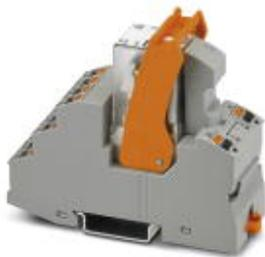
Установленный релейный модуль: релейный блок, функциональный вставной блок, реле с силовыми контактами и поддерживающая скоба, допуски согласно ATEX/IECEx (зона 2) и для взрывоопасной зоны класса I, разд. 2, Зажимы Push-in, 4 переключающих контакта, Входное напряжение: 230 В AC
