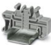
Концевой держатель для быстрого монтажа, для монтажной рейки NS 35/7,5 или NS 35/15, с возможностью нанесения маркировки, ширина: 9,5 мм, цвет: серый
