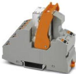
Установленный релейный модуль: релейный блок, функциональный вставной блок, реле с силовыми контактами и поддерживающая скоба, допуски согласно ATEX/IECEx (зона 2) и для взрывоопасной зоны класса I, разд. 2, Винтовые зажимы, 4 переключающих контакта, Входное напряжение: 120 В AC
