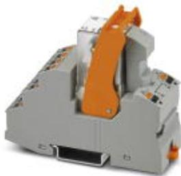
Установленный релейный модуль: релейный блок, функциональный вставной блок, реле с силовыми контактами и поддерживающая скоба, допуски согласно ATEX/IECEx (зона 2) и для взрывоопасной зоны класса I, разд. 2, Винтовые зажимы, 4 переключающих контакта, Входное напряжение: 24 В DC
