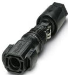
Фотогальванический штекерный соединитель, Разъем, материал корпуса: PPE, цвет: черный, полюсов: 1, сечение жилы мин.: 2,5 мм<sup>2</sup>, сечение жилы макс.: 6 мм<sup>2</sup>, расчетный ток: 27 А, Тип подключения: Пружинные контакты, Тип контактов: Штифт. деблокировка возможна только с инструментом
