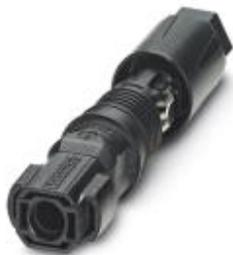
Фотогальванический штекерный соединитель, Разъем, материал корпуса: PPE, цвет: черный, полюсов: 0, сечение жилы мин.: 6 мм<sup>2</sup>, сечение жилы макс.: 16 мм<sup>2</sup>, расчетный ток: 40 А, Тип подключения: Пружинные контакты, Тип контактов: Штифт. деблокировка возможна только с инструментом
