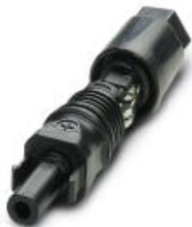
Фотогальванический штекерный соединитель, Разъем, материал корпуса: PPE, цвет: черный, полюсов: 1, сечение жилы мин.: 2,5 мм<sup>2</sup>, сечение жилы макс.: 6 мм<sup>2</sup>, расчетный ток: 27 А, Тип подключения: Пружинные контакты, Тип контактов: Розетка. деблокировка возможна только с инструментом
