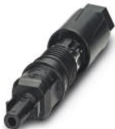
Фотогальванический штекерный соединитель, Разъем, материал корпуса: PPE, цвет: черный, полюсов: 0, сечение жилы мин.: 6 мм<sup>2</sup>, сечение жилы макс.: 16 мм<sup>2</sup>, расчетный ток: 40 А, Тип подключения: Пружинные контакты, Тип контактов: Розетка. деблокировка возможна только с инструментом
