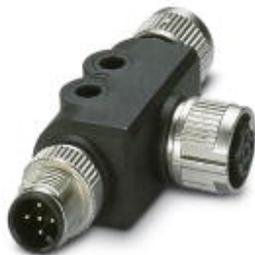
T-распределитель, CANopen®, DeviceNet™, 5-полюсн., Гнездо прямое M12, A-кодирование, к Гнездо прямое M12, A-кодирование и Штекеры прямое M12, A-кодирование, параллельный распределитель
