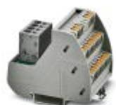
Модуль VARIOFACE, с зажимами Push-in, для распределения питания с двумя шинами для распределения потенциалов (P1, P2), устанавливается на монтажные рейки NS 35. Ширина модуля: 57,1 мм
