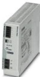
Источник питания TRIO для установки на несущую рейку с регулированием в первичной цепи, вход: 1-фазный, выход: 48 В DC / 5 А, динамический разгон, быстрый монтаж жестких и гибких проводников с наконечником без инструмента
