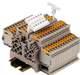
Держатель этикеток SnapMark разработан специально для двухуровневых клемм IDC 1.5N серии I. Гибкий поворотный механизм обеспечивает удобство установки и извлечения перемычек. Возможность прикрепления четырех маркировочных этикеток DEK 5 или двух маркировочных элементов для разъемов WS 10/5 Middle.
