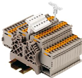
Держатель этикеток SnapMark разработан специально для двухуровневых клемм IDK 1.5N серии I. Гибкий поворотный механизм обеспечивает удобство установки и извлечения перемычек. Возможность прикрепления четырех маркировочных этикеток DEK 5 или двух маркировочных элементов для разъемов WS 10/5 Middle.
