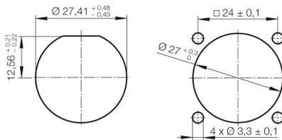
Разрез в сборе: 1-й для центрального кабельного ввода/2-й-для монтажа с помощью 4 винтов М3
