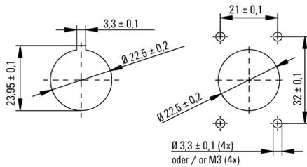
Разрез в сборе: 1-й для центрального кабельного ввода/2-й-для монтажа с помощью 4 винтов М3
