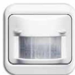
**Датчик движения** оборудован комфортной или мультилинзой. Комфортная линза имеет горизонтальную зону обнаружения. Многоэлементная линза, помимо горизонтальной зоны обнаружения, имеет зону, направленную вниз под углом 7 градусов.
