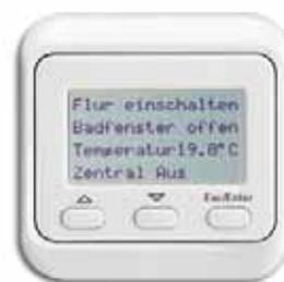
**ЖК-дисплей** служит для отображения текстов, числовых значений и рабочих состояний. С помощью кнопок можно напрямую активировать выполнение функций и прокручивать экранные формы 8-строчного дисплея.
