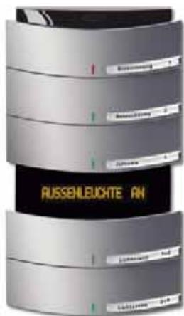
Дополнительная кнопка может использоваться для сохранения световых сцен в памяти, включения подсветки поля маркировки и прокрутки отображаемых на дисплее текстов.
