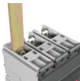
Подключение шины к выводу F
