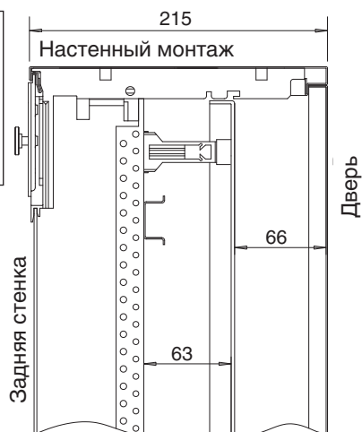
Шкаф с распре- делительной панелью
