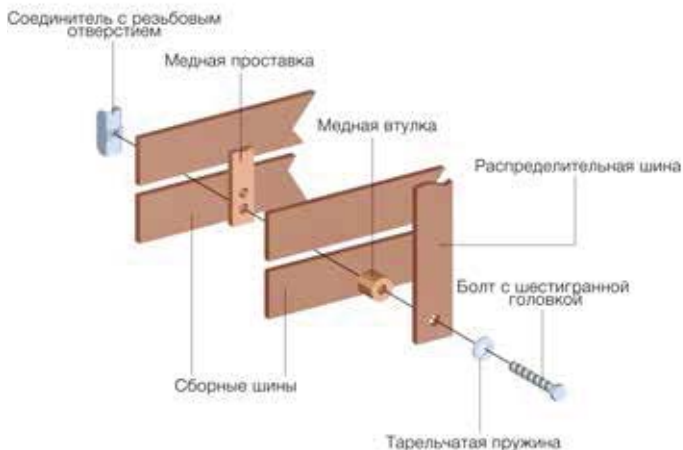
Рис. 1.4. Схема построения электрических контактных соединений с помощью медных дистанционных роликов
