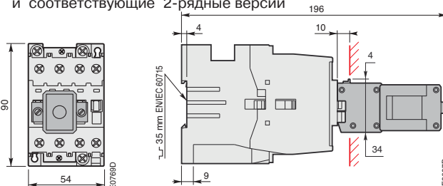
AL 30, AL 40, TAL 30, TAL 40 + CA 5 4-полюсный блок вспомогательных контактов для фронтальной установки и соответствующие 2-рядные версии
