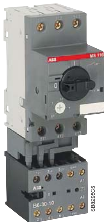
Устройство прямого пуска B6-30-10 + BEA 7/116 + MS 116
