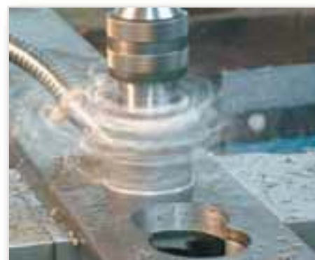
Сверление листовой стали с ровной поверхностью
