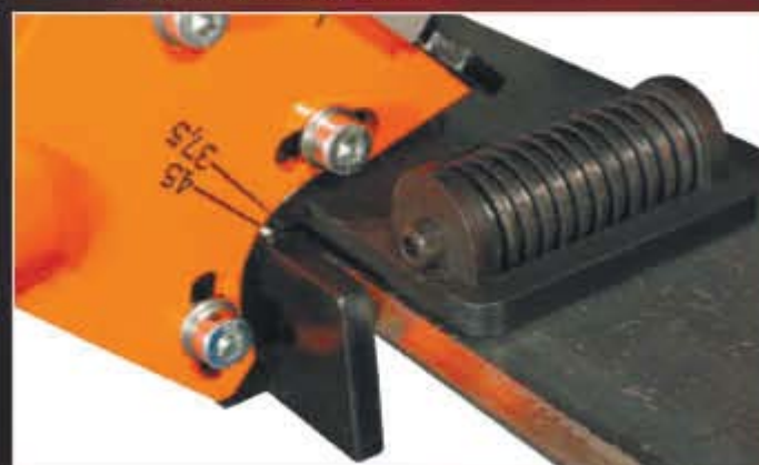
2 фрезерующих диска с 6 режущими пластинами у каждого
