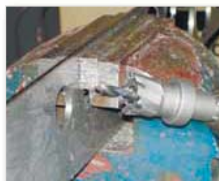
Ручное сверление до Ø 30 мм
