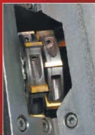
2 фрезерующих диска с 6 режущими пластинами у каждого
