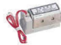
Когда напряжение питания находится в диапазоне от 85 до 110% относительно номинального значения управляющего напряжения, электромагнит может гарантированно включить выключатель. Режим работы электромагнита включения – кратковременный. Он не может находиться под напряжением долгое время. Время подачи напряжения – от 0,2 до 2 с, в противном случае он может быть поврежден.
