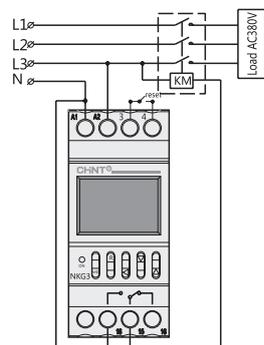
Схема подключения для управления трехфазной нагрузкой (катушка контактора AC220В).
