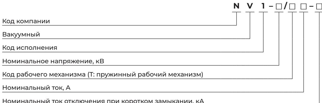
**Пример записи:** Вак. выключатель NV1 24кВ, ном. ток 630А, 25кА, межф. расст.210мм, ЦУ220В перем. тока, стац. – вакуумный автоматический выключатель номинального напряжения 24 кВ, номинальный ток 630 А, наибольшая отключающая способность 25 кА, межфазное расстояние 210 мм, переменного тока 220 В стационарного исполнения.
