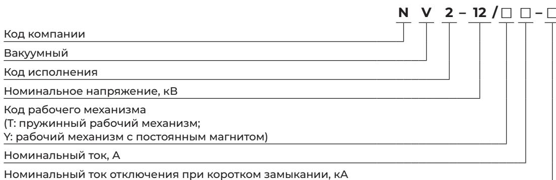
**Пример записи:** Вак. выключатель NV2 12кВ, ном. ток 1250А, 40кА, межф. расст.210мм, ЦУ220В перем. тока, стац. – вакуумный автоматический выключатель номинального напряжения 12 кВ, номинальный ток 1250 А, наибольшая отключающая способность 40 кА, межфазное расстояние 210 мм, переменного тока 220 В, стационарного исполнения.
