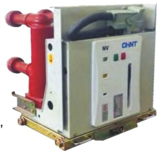
Применяются в составе распределительных устройств 6-35 кВ для управления и защиты присоединений. Применение технологии гашения дуги в вакууме позволяет достичь большого электрического и механического ресурса аппаратов, высокого уровня отключающей способности, а также обеспечить минимальный уровень коммутационных перенапряжений в сети. Выключатели могут комплектоваться на выбор пружинно-моторным или электромагнитным приводом.
