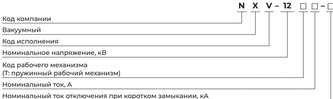
**Пример записи:** Вак. выключатель NXV 12кВ, ном. ток 2500А, 40кА, межф. расст.275мм, ЦУ110В перем. тока, выдв. – вакуумный автоматический выключатель номинального напряжения 12 кВ, номинальный ток 2500 А, наибольшая отключающая способность 40 кА, межфазное расстояние 275 мм, переменного тока 110 В, выдвижного исполнения.
