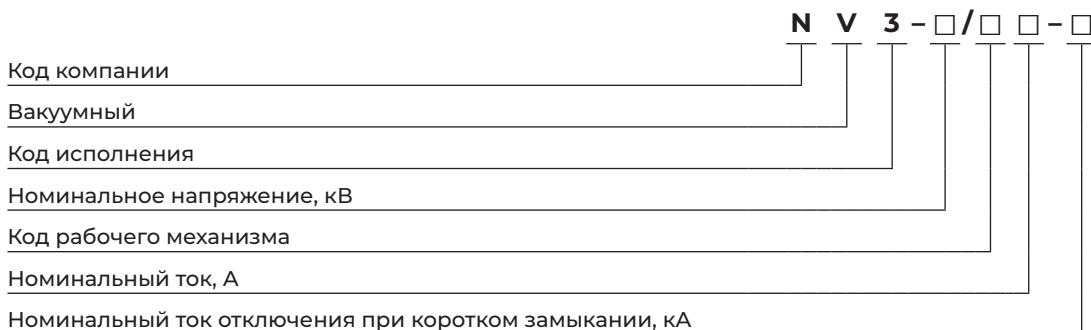
**Пример записи:** Вак. выключатель NV3 40,5кВ, ном. ток 2500А, 40кА, межф. расст.275мм, ЦУ110В переменного тока, выдв. – вакуумный автоматический выключатель номинального напряжения 40,5 кВ, номинальный ток 2500 А, наибольшая отключающая способность 40 кА, межфазное расстояние 275 мм, переменного тока 110 В, выдвижного исполнения.
