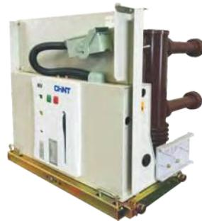
Применяются в составе распределительных устройств 6-35 кВ для управления и защиты присоединений. Применение технологии гашения дуги в вакууме позволяет достичь большого электрического и механического ресурса аппаратов, высокого уровня отключающей способности, а также обеспечить минимальный уровень коммутационных перенапряжений в сети.
