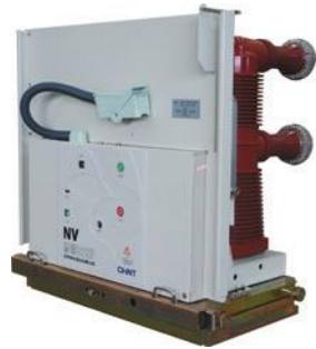
Применяются в составе распределительных устройств 6-35 кВ для управления и защиты присоединений. Применение технологии гашения дуги в вакууме позволяет достичь большого электрического и механического ресурса аппаратов, высокого уровня отключающей способности, а также обеспечить минимальный уровень коммутационных перенапряжений в сети. Выключатели могут комплектоваться на выбор пружинно-моторным или электромагнитным приводом.
