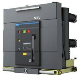
Применяются в составе распределительных устройств 6-35 кВ для управления и защиты присоединений. Применение технологии гашения дуги в вакууме позволяет достичь большого электрического и механического ресурса аппаратов, высокого уровня отключающей способности, а также обеспечить минимальный уровень коммутационных перенапряжений в сети. Выключатели могут комплектоваться на выбор пружинно-моторным или электромагнитным приводом.
