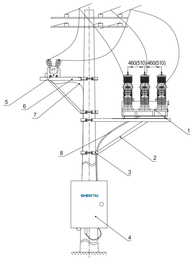
**Габаритные и установочные размеры вакуумного выключателя NVW2-40,5 с сердечным ТТ или без ТТ**
