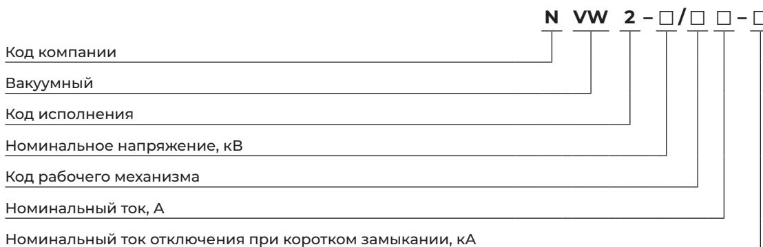
**Пример записи:** Вак. выключатель NVW2 40,5кВ, ном. ток 2500А, 31,5кА, стац. – вакуумный автоматический выключатель наружной установки номинального напряжения 40,5 кВ, номинальный ток 2500 А, наибольшая отключающая способность 31,5 кА, стационарного исполнения.
