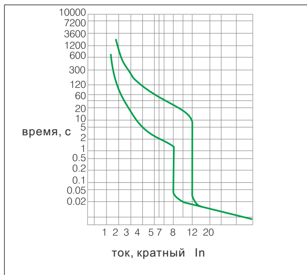
Характеристики выключателей NM1-630, NM1-800
