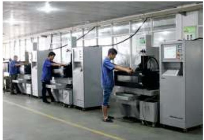
11 станков среднескоростной резки провода
