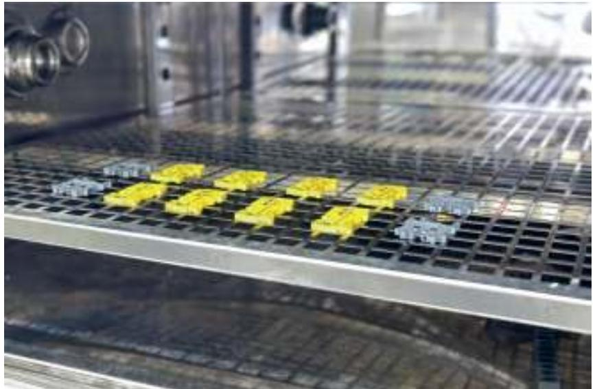
Циклические температурные испытания клемм на DIN-рейку
