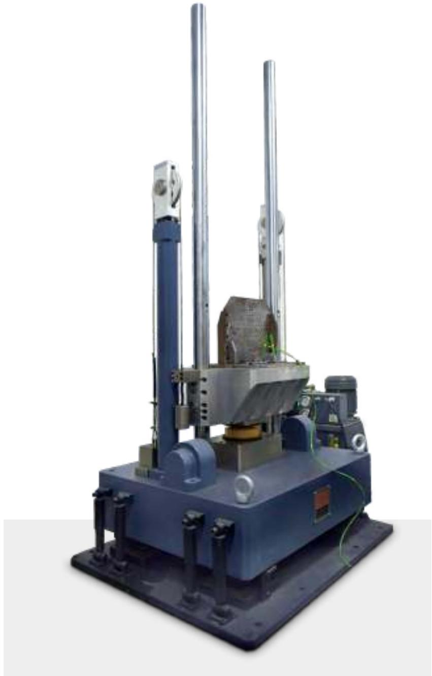
Испытательная установка ударопрочности
