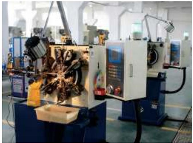
Автоматический станок по производству пружин
