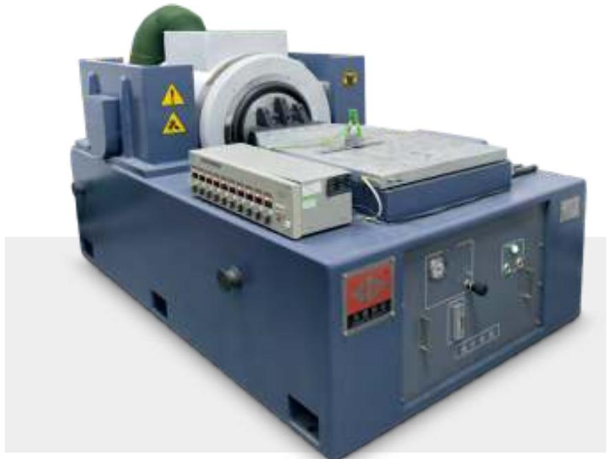
Испытательная установка для вибрационных нагрузок
