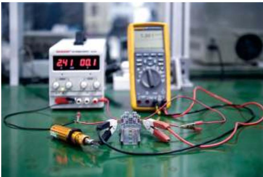
Испытание винтовых клемм на падение напряжения
