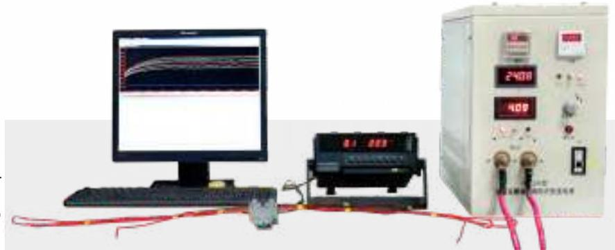
Испытание на нагрев клемм под нагрузкой
