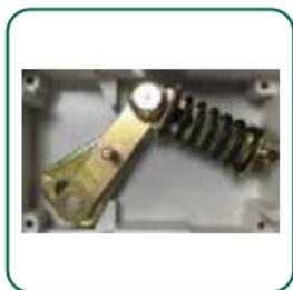
**Пружинный механизм расцепления**
