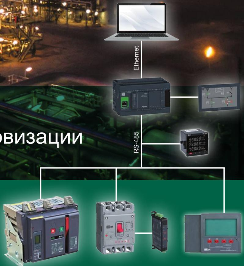
**Оборудование DEKraft позволяет реализовать комплексное решение для систем электроснабжения с возможностью диспетчеризации, удаленного мониторинга, управления и измерения параметров электрической энергии. Система «умного» распределительного устройства состоит из подключаемых устройств, контроллерного оборудования и панелей управления.**
