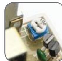
Возможность корректировки выходного напряжения
