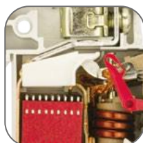
Рабочая зона закрыта диэлектриком
