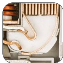
Рабочая зона закрыта диэлектриком
