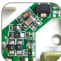
Встроенная защита от перенапряжения
