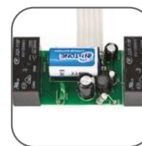
Два встроенных реле на токи до 16 А
