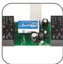
Два встроенных реле на токи до 8 А
