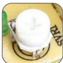
Возможность корректировки выходного напряжения
