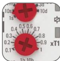
Возможность регулировки времени от 10 до 100% от предустановленного
