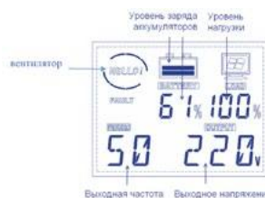
Индикация дисплея в батарейном режиме
