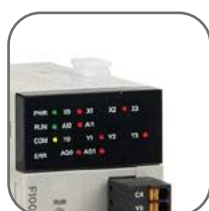
Индикация состояния входов/выходов
