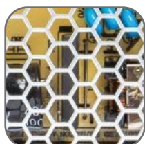
Вентиляционные отверстия для лучшего теплоотвода
