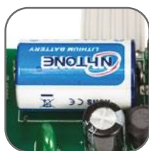
Часы реального времени работают 10 лет без питания
