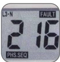
Пофазное отображение напряжений
