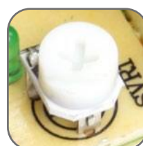
Возможность корректировки выходного напряжения
