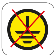
Корпус не требует заземления
