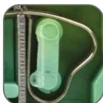
Токоведущая пластина выполнена из луженой меди
