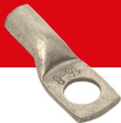
Облегченная серия силовых наконечников ТМЛ-Р EKF PROxima используется для оконцевания проводов и кабелей с медными жилами посредством опрессовки для последующего болтового соединения проводника с оборудованием или шиной. Особенностью данной серии являются обратный радиус штамповки лопатки, что позволило сохранить монтажные размеры площадки под болт и увеличить длину хвостовика при сохранении общей длины наконечника.
