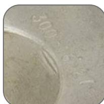
Штампованная маркировка типоразмера на каждом наконечнике
