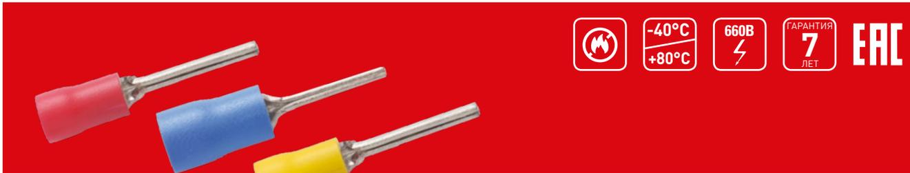
Наконечник штыревой круглый изолированный НШКИ EKF PROxima предназначен для оконцевания опрессовкой медных проводов и последующего крепежа наконечников к электрооборудованию с контактными гнездами штифтового типа (автоматическим выключателям, УЗО, клеммным блокам и т. п.). Опрессовка наконечников выполняется поверх ПВХ манжеты, а не металлической втулки.
