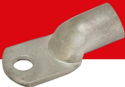
Облегченная серия силовых наконечников JG EKF PROxima используется для оконцевания проводов и кабелей с медными жилами посредством опрессовки для последующего болтового соединения проводника с оборудованием или шиной. Наконечники изготавливаются из медных труб различного диаметра.
