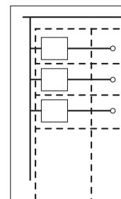
Форма разделения и более высокая степень защиты (выше IP2X или IPXX B) являются предметом договора между производителем и пользователем (инвестором). Внутреннее разделение используется для защиты обслуживающего персонала и оборудования всюду там, где на распределительном щите производятся работы, и где по эксплуатационным причинам оборудование не может быть выключено и проводка
