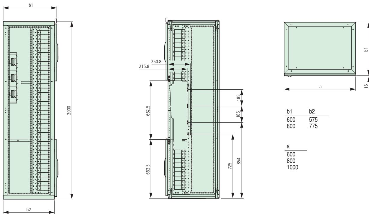
**Пустые секции XG с монтажным комплектом для монтажа, настраиваемым по высоте**
