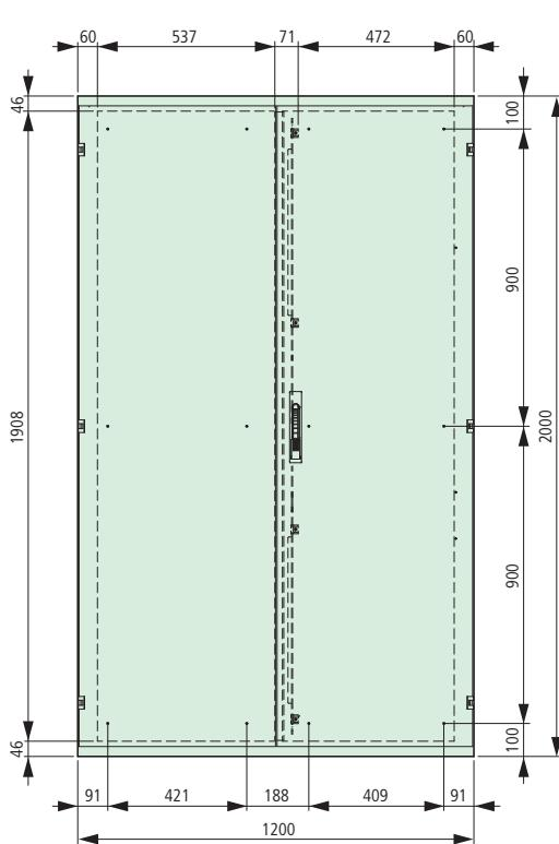
**Монтажный комплект для монтажной панели на высоту секции XSMFB20...**
