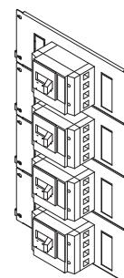
Установка коммутационных и защитных приборов на заранее просверленные монтажные панели со всеми крепежными и соединительными отверстиями, которые немедленно подготовлены для монтажа.
