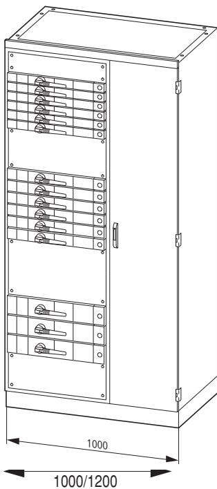
Ширина секции 1000 и 1200 мм (горизонтальная установка)
