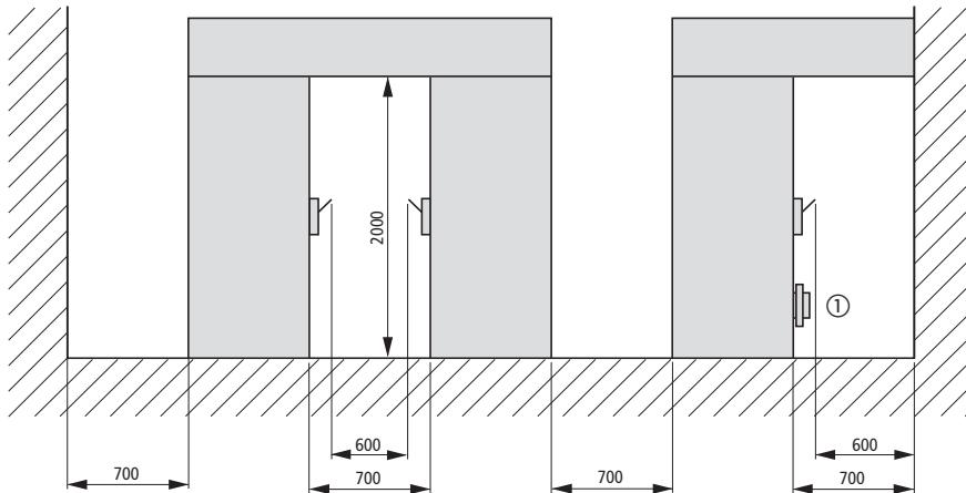
① Блок выдвижного исполнения в разомкнутом состоянии
