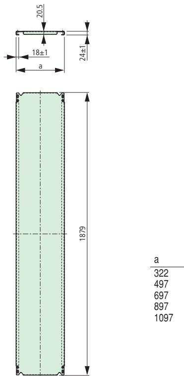
**Размеры отверстия в полу для секции XSFB...**
