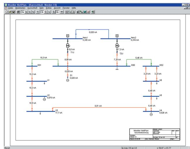
При помощи программного обеспечения NetPlan проектируете и проверяете узловые низкого напряжения (ячеистые сети и радиальные сети) с уверенностью и без проблем.
