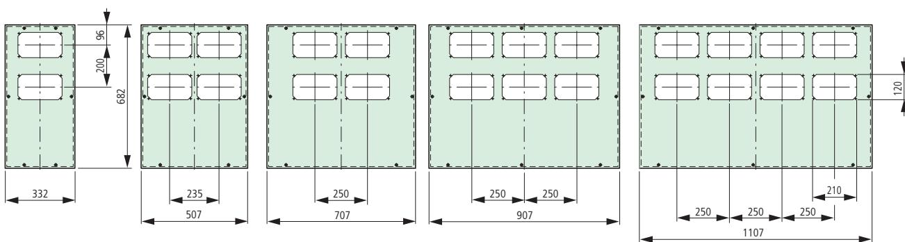
**Верхняя панель с вырезом, глубина секции 600 мм**
