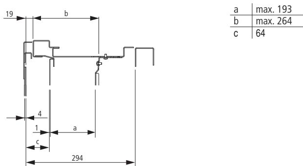
**Секция XF с задними распределительными сборными шинами для автоматического выключателя NZM1-3 XDSF...**
