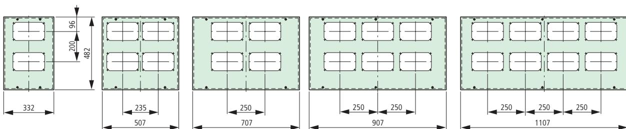
**Верхняя панель для проходных изоляторов, глубина секции 800 мм**
