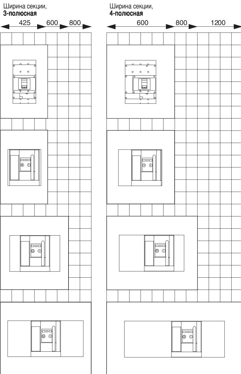
Автоматический выключатель типа NZM4,
