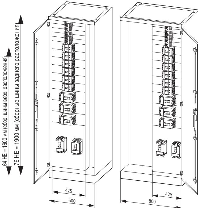
Отсек для присоединения кабелей в различных монтажных положениях шириной 200 и 400 мм.
