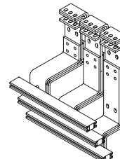
Система присоединения кабелей: без необходимости сверления на всю ширину секции с контактами спереди
