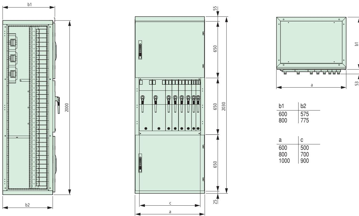
**Секция XF с вертикально установленными блоками предохранительных выключателей нагрузки SASIL**
