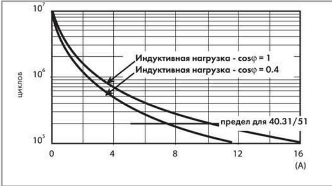
**F 40 - Электрическая долговечность (AC) при номинальной нагрузке**
