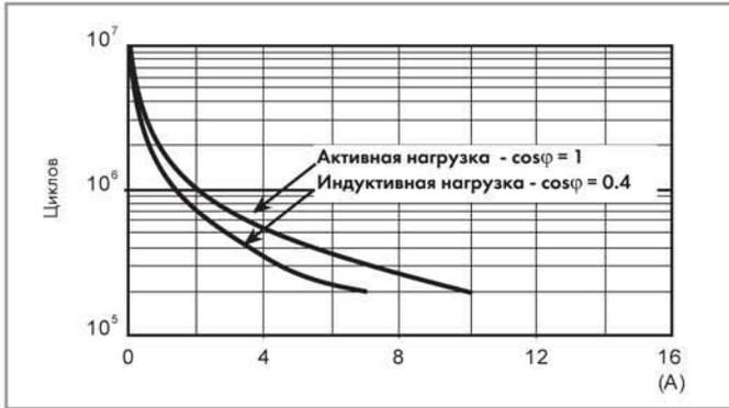
**F 58 - Электрическая долговечность (АС) при ном. нагрузке**
