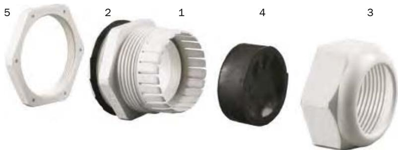
Сальник состоит из корпуса (1), уплотнителя (4), гайки уплотнения (3), прокладки (2) и фиксирующей гайки (5). Уплотнитель и прокладка выполнены из каучука.
