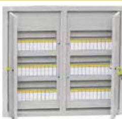
ЩРв-72з-3 36 УХЛ3 IP31 TREND | 72             | RAL 7035 | Количество вводов: по 1 отверстию 140×30 мм (сверху и снизу).<br>Масса: 9,9 кг | Корпус: 540×600×120.<br>Ниша: 505×565×125 | МКМ14-V-72-30-T  |
