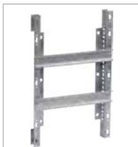
Съемная монтажная рама – возможен электромонтаж оборудования вне корпуса (расстояние между DIN-рейками 125 мм).
