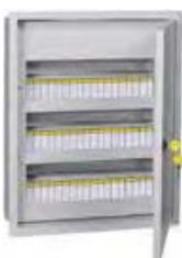
ЩРв-54з-3 36 УХЛ3 IP31 TREND | 54             | RAL 7035 | Количество вводов: по 1 отверстию 140×30 мм (сверху и снизу).<br>Масса: 7,4 кг | Корпус: 540×440×120.<br>Ниша: 505×405×125 | МКМ14-V-54-30-T  |
