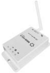
Предназначен для сопряжения компонентов беспроводной сети ME6 (модули, драйверы, датчики) с сетью Интернет через интерфейс Ethernet. Обеспечивает обмен данными между удаленным «облачным» сервером и компонентами беспроводной сети ME6.
