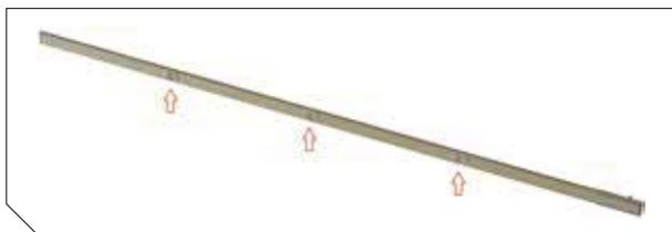
Шинопровод с 3 точками отвода для подключения светильников
