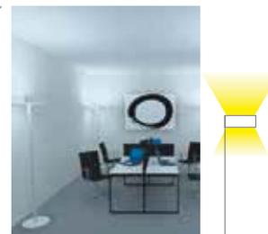
Световая картина при использовании напольных светильников прямого и отраженного света
