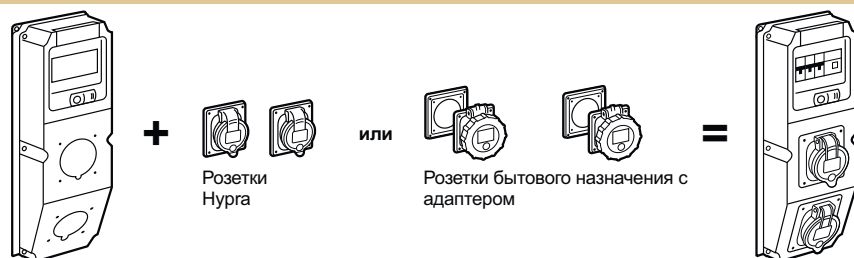
Щиток с отверстиями
