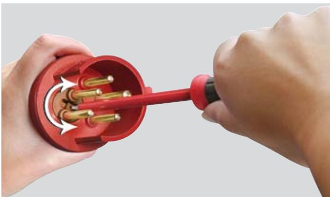
При помощи вилки-фазоинвертора можно оперативно менять направление вращающегося трехфазного поля. Представьте: теперь не нужно тратить время на коммутирование – фазировка меняется с помощью одного поворота отвертки! Два фазных полюса расположены на поворотной платформе, которая поворачивается на 180°.
