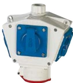
Для подвешного монтажа, с разгрузкой натяжения. Корпуса и розетки изготовлены из АМАПЛАСТА (AMAPLAST) или стойкого к воздействию химикалий АМЕЛАНА (AMELAN), ударопрочные и термостойкие. Каждый модуль DELTA-BOX поставляется в комплекте с подвесной скобой. Могут поставляться с классом защиты IP 44, IP 67 и IP 68.
