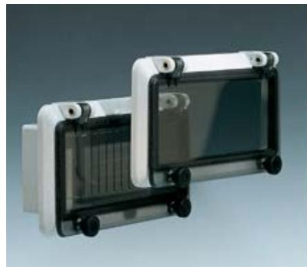
Шарнирные окна подходят для встраивания в корпуса (такие, как, например, пустые корпуса от МЕННЕКЕС), либо для установки в оборудование, щиты и распределительные шкафы. Благодаря кронштейнам с DIN-рейкой шарнирные окна с установленными модульными приборами можно размещать на дверцах распределительных шкафов и крышках корпусов. Шарнирные окна с крышкой для защиты от контакта с токопроводящими частями или без
