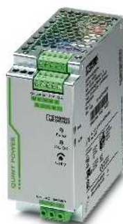
Источник питания, однофазный, 12 В пост. тока, 15 А
