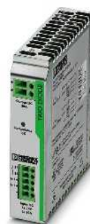
Модуль резервирования, 12-24 В пост. тока, 2x 10 А, 1x 20 А
