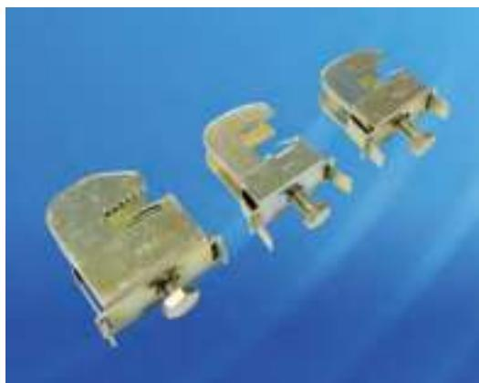
Универсальный зажим, предназначенный для подключения плоских шин, а также кабелей круглого сечения. Открытая клеммная камера и невыпадающий болт обеспечивают быстрый и простой монтаж
