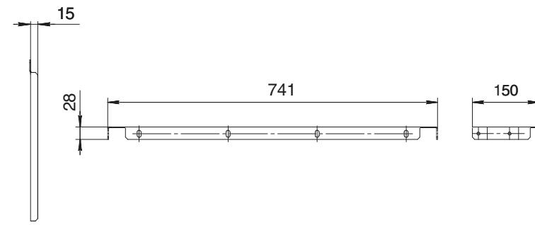
\* Устанавливается вместо стандартной перегородки, разделяющей отсек сборных шин и отсек присоединений
