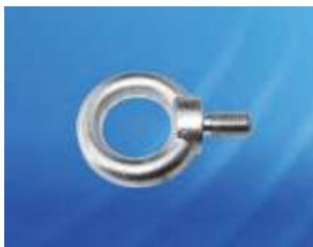
Предназначен для транспортировки напольных распределительных шкафов с помощью крана. Легко монтируется в резьбовые отверстия рамы взамен винтов для крепления потолочной панели, диаметр резьбы M12. Предельно допустимая статическая нагрузка 200 кг при транспортировке под углом 60°
