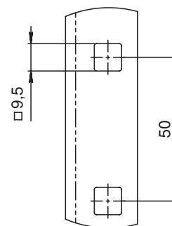
Монтаж рамы модульной на шкаф
