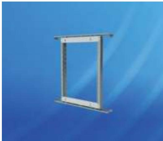
Предназначена для монтажа внутреннего оборудования 19" в напольных распределительных шкафах. Устанавливается только в шкафы шириной 800 мм. Монтаж производится на монтажные рейки, установленные по глубине шкафа. Возможно регулирование установки по глубине. Блокировка производится двумя замками под ключ с двойной бородкой 5 мм. Право или левостороннее открывание.
