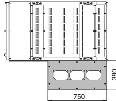
Пример шинного моста одной секции распределительного устройства
