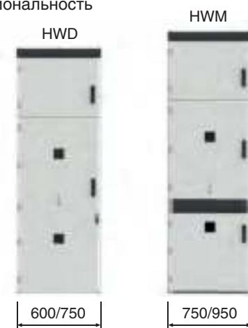
Универсальность конструкции корпусов позволяет ограничиться всего двумя типоразмерами для моделей HWD и HWM, которые перекрывают всю сетку функциональных исполнений по устанавливаемому оборудованию. Сокращение типоразмеров позволяет оптимизировать складские заделы заготовок для сборки КРУ.
