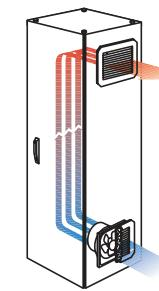
**Применение устройств охлаждения.** Устройства охлаждения используются для понижения температуры внутри шкафа. Применение таких устройств не влияет на степень защиты распределительного щита. Встроенный фильтр обеспечивает их использование в неблагоприятных условиях загрязненного производства, где воздух насыщен частицами пыли и масла
