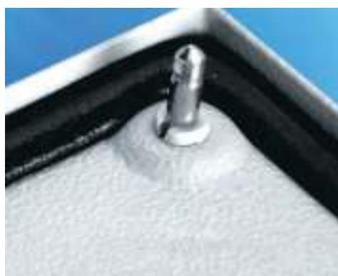
1. Корпус выполнен из одного листа стали. Стыки корпуса сварены непрерывным циклом для придания жесткости и плотности. Желоб по краю корпуса обеспечивает дополнительную жесткость корпуса и препятствует попаданию грязи и воды внутрь при открытии шкафа.
