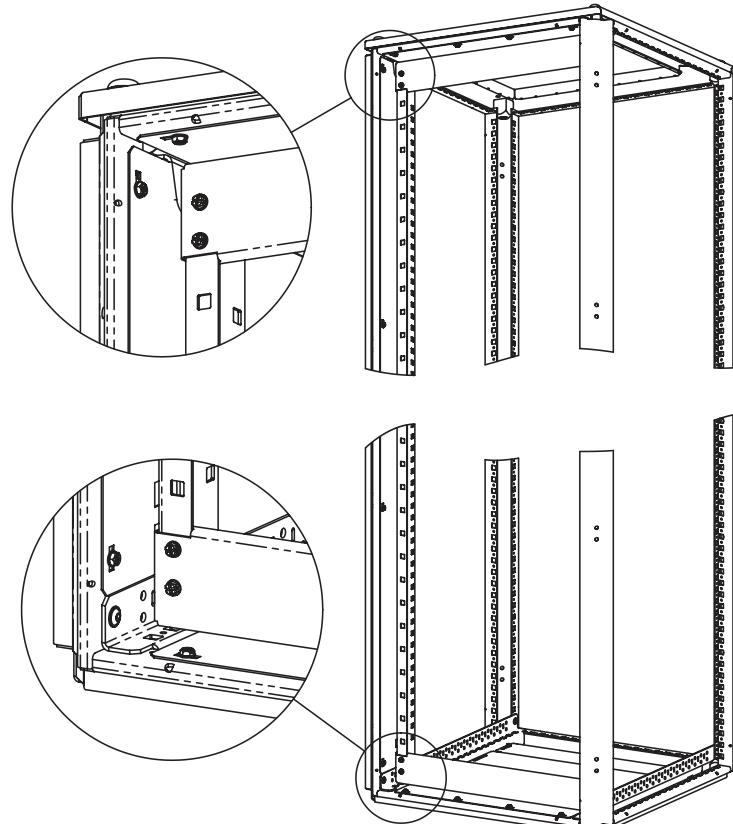
Монтаж комплекта защиты от прикосновения на раму шкафа осуществляется при помощи самонарезающих винтов (поставляются в комплекте)
