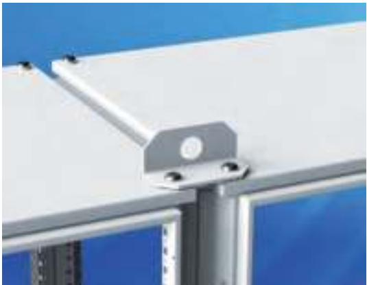
Предназначен для равномерного распределения силы подъема при транспортировки двух соединенных напольных распределительных шкафов с помощью крана. Легко монтируется в резьбовые отверстия рамы, предназначенные для крепления потолочной панели, диаметр резьбы 12 мм.. Предельно допустимая статическая нагрузка 500 кг при транспортировке под углом 60°
