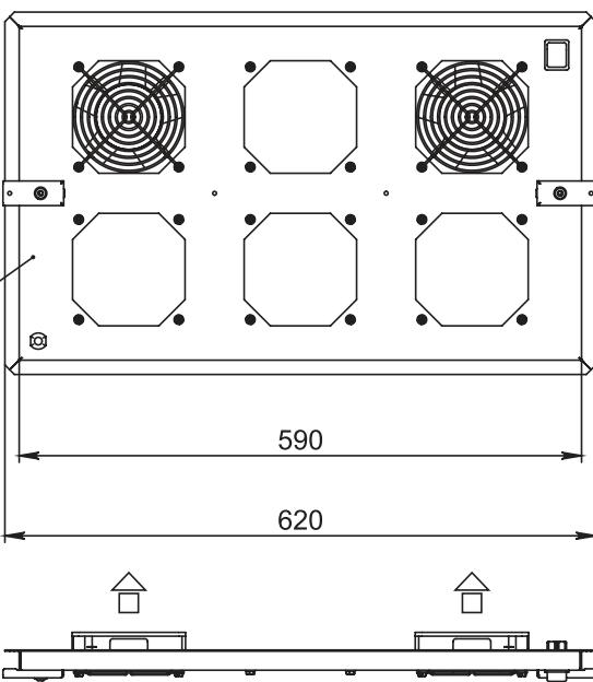
для сетевых и телекоммуникационных шкафов типа IPx - устанавливается в подготовленный проем рамы IF, крепление с помощью закладных гаек и винтов M5/M6
