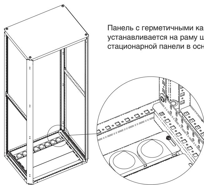
Панель с герметичными кабельными вводами устанавливается на раму шкафа вместо стандартной стационарной панели в основании рамы
