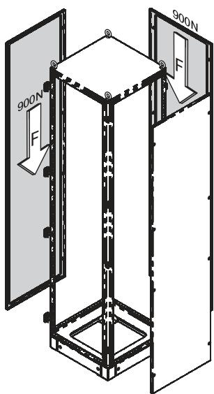
Нагрузка на боковую и заднюю стенки
