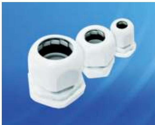
Наличие зажимных элементов обеспечивает равномерное обжатие и разгрузку от натяжения. Неопреновый уплотнитель гарантирует оптимальную герметизацию в месте крепления к корпусу
