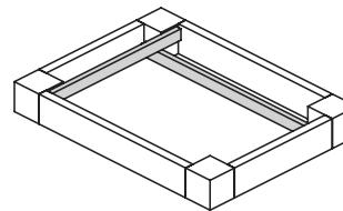
Есть возможность осуществлять фиксацию кабелей в цоколе шкафа при помощи монтажных траверс (заказываются отдельно, см. стр. 132) через закладные гайки M6 (заказываются отдельно, см. стр. 200), которые устанавливаются в предусмотренные для этого отверстия в углах цоколя
