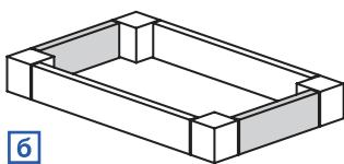
Предназначен для монтажа к полу настенных корпусов для средств автоматизации, напольных распределительных шкафов, нижних частей пультов. Высота цоколя 100, 200 мм. Состоит из передних, задних и боковых элементов
