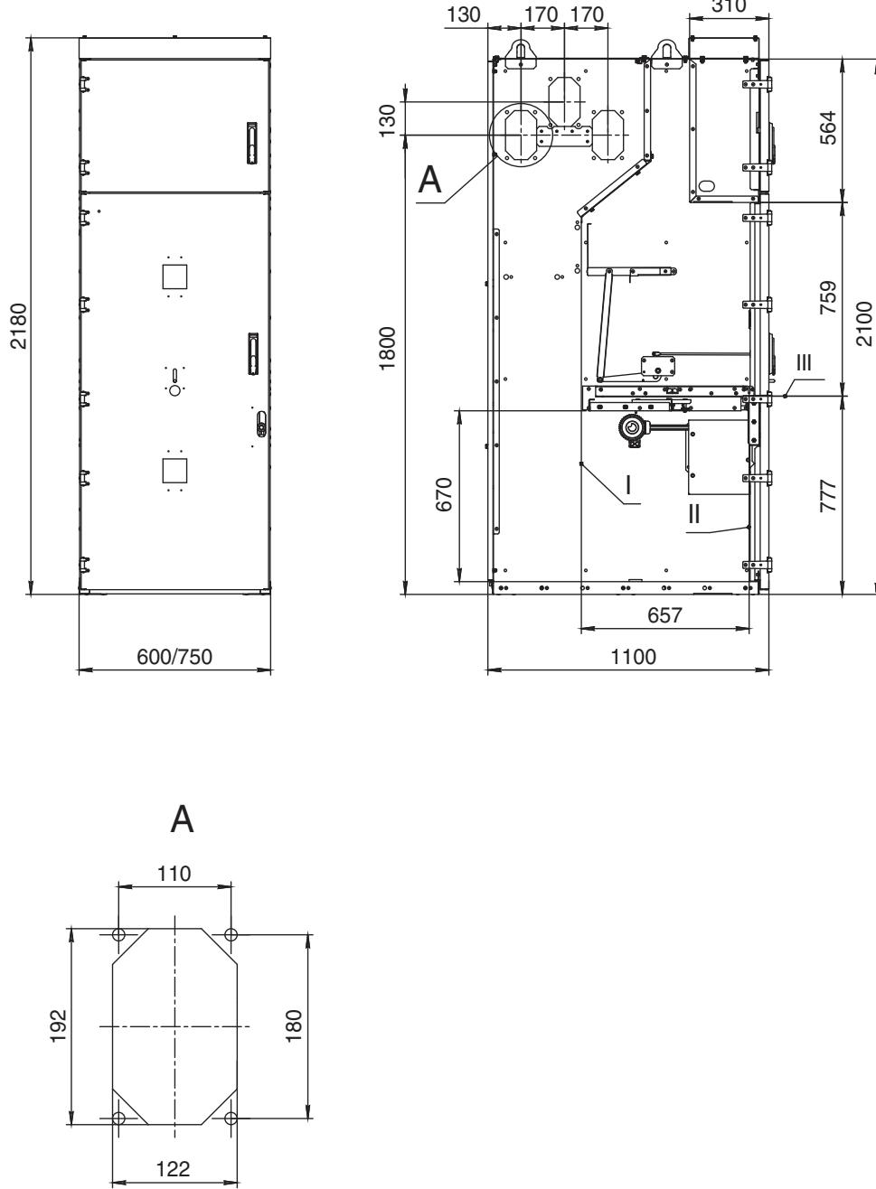
I – поверхность панели изоляторов;
