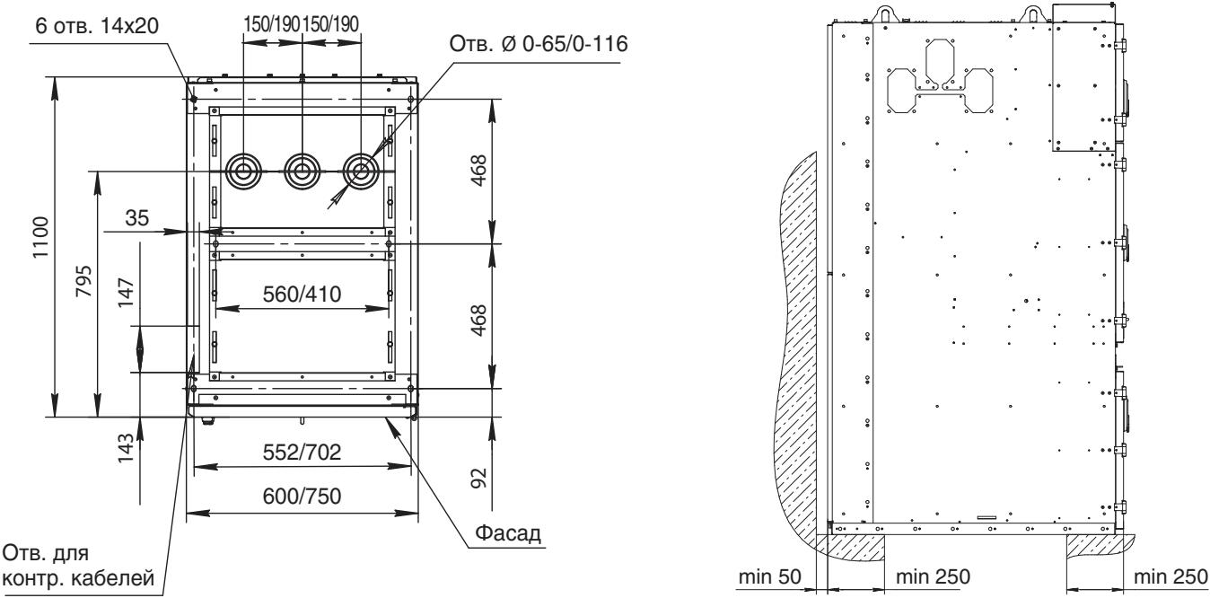
Базовое исполнение корпуса HWM комплектуется панелью кабельного ввода для трёх одножильных, либо трёх трёхжильных кабелей с возможностью перемещения по монтажной поверхности основания. Проёмы закрываются глухими панелями из оцинкованного листа. Максимальное количество панелей кабельного ввода – 4
