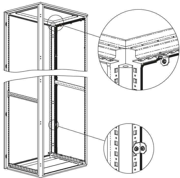
Монтаж разделительной панели на раму шкафа осуществляется при помощи самонарезающих винтов и кронштейнов (поставляются в комплекте)
