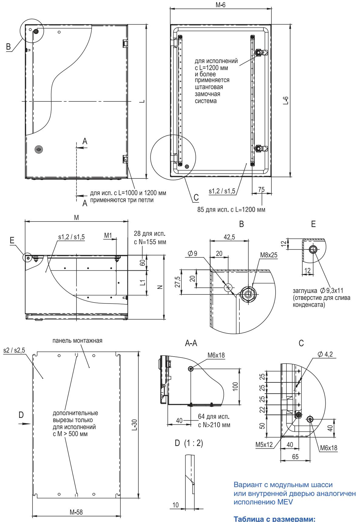
Вариант с модульным шасси
