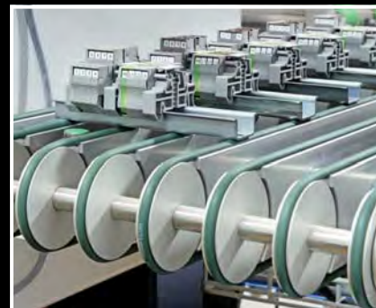
Блок для сортировки и накопитель для клеммных сборок
