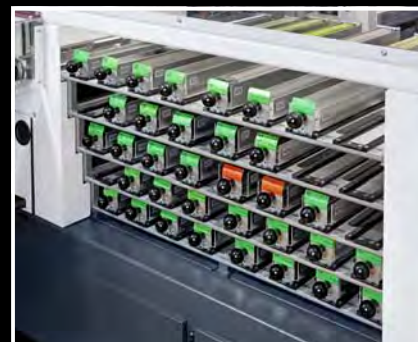
Хранение до 80 магазино-мест для рядных клемм, предохранительных автоматов и др.
