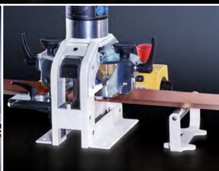
Резка токовой шины
